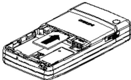
Поместите аккумулятор обратно в его слот, причем позолоченные контакты аккумулятора должны быть направлены к соответствующим позолоченным контактам сбоку телефона.
